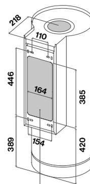
Rückwertiger Ausgang; Bitte entfernen Sie die Metallplatte 385 x 164 mm
