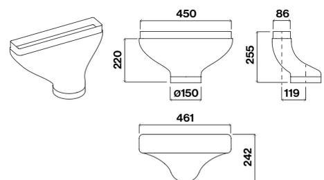
*\*Wird zur Verbindung von Piano zum Sockelmotor bzw. weiterem Kanalsystem benötigt.*
