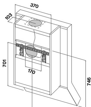
Rückwertiger Ausgang; Bitte entfernen Sie die Metallplatte 170 x 165 mm
