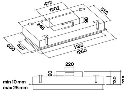
Tragfähigkeit der Zwischendecke muss mind. dem Gewicht der Haube (50kg ohne Motor / 60kg mit Motor) entsprechen.
