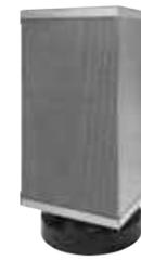
Long Life-Aktivkohlefilter, Ø 150 mm, passives Filtersystem, Edelstahlgehäuse, begrenzt regenerierbar, spülmaschinengeeignet (Spülen bei max. 50° C), Trocknen bei max. 180° C für 25 min. im Backofen, HxBxT: 300x160x160 mm, Kompatible Modelle s. Produktbeschreibung).
